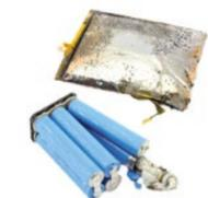
Hüllenlose, aufgeblähte und beschädigte Akkus
