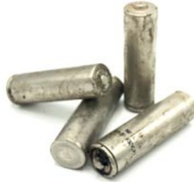
Piles vides et sans gaine
